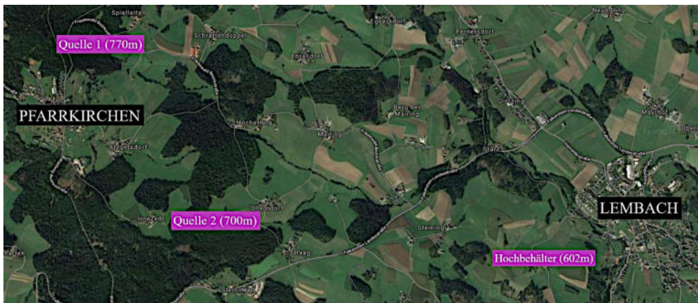
Die zwei Quellen in Ollerndorf (1968) und Spielleiten (1971) liefern das Lembacher Trinkwasser und sichern durch ihre Höhenlage den Wasserdruck.
